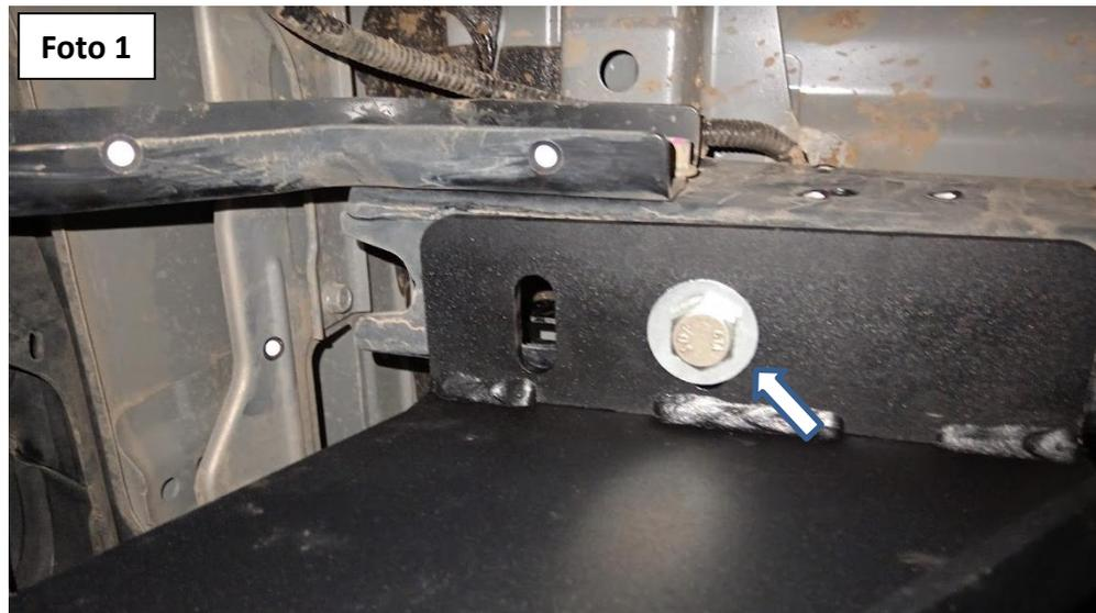
2. Presente el Tirón en el vehículo e introduzca (2) Soleras con tornillo de  $\frac{1}{2}$  x  $1 \frac{1}{2}$ " utilizando la guía para tornillo, (2) rondanas planas y (2) tuerca de seguridad. No apriete aún. Repita para el lado contrario. **Foto 2 y 3.**
