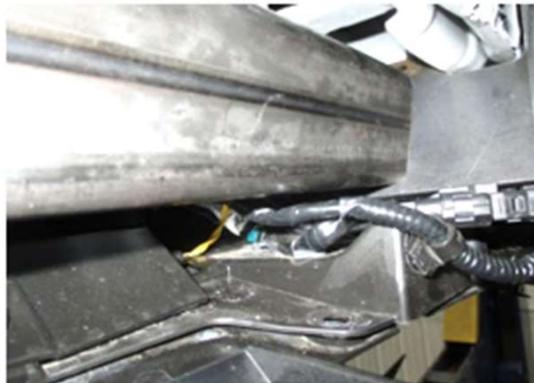
6. Retire las guías de alambre y asegure con tuercas flange de 7/16" y tornillos M14 con sus rondanas planas y de presión.
