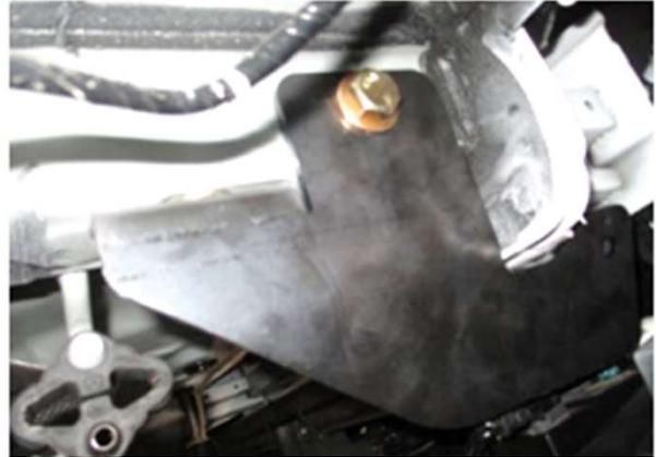
8. Reinstale el soporte de la defensa utilizando los separadores cuadrados entre el soporte y el chasis, alineados con las tuercas soldadas.
