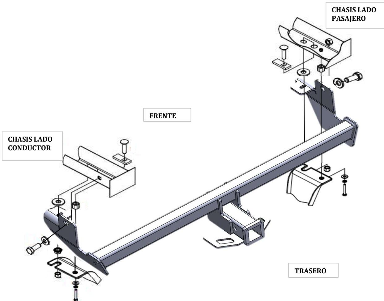
Enrosque el tornillo en la guía de alambre como se muestra. Coloque la calza en la guía e introdúzcala por el orificio más grande del chasis como se muestra. Jale la guía por el orificio pequeño de tal manera que salga la rosca del tornillo.
