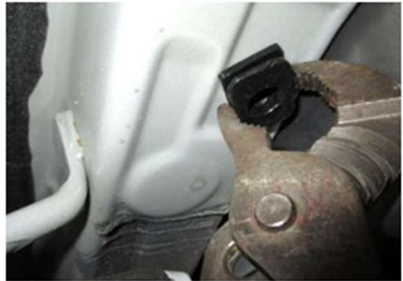
3. Con un mototool y una punta de tuxteno, agrande el barreno que está entre la tuerca soldada y el agujero donde retiró el clip, para poder pasar el tornillo y la calza con la guía.
