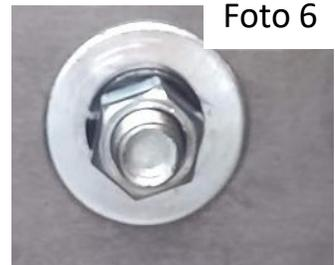
5. Con ayuda, coloque el centro del porta accesorios en su posición. **(Foto 6)**. Ubique los barrenos cuadrados del centro y coloque 3 tornillo cabeza coche de 3/8 x 1. Fíjelos con 3 rondanas planas de 3/8 y 3 rondanas de presión de 3/8M. Repita el procedimiento en el otro lado del porta accesorios. **(Foto 7)**
