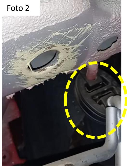
2. Ubique el barreno grande en la parte inferior del Chasis, Por aquí entrarán las guías de tornillos. Utilizando una de las guías de tornillos, introduzca la solera con tornillo de 1 ½ " de largo en el barreno lateral trasero del chasis. Guíelo hasta su posición final en el barreno que apunta hacia abajo. Repita este paso hasta tener dos soleras por lado del vehículo (**Foto 3**).
