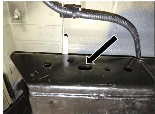
2. Introduzca las soleras con tornillo de  $\frac{1}{2}$ " y la del tornillo de  $\frac{3}{8}$ " como se muestra. Foto 3.
