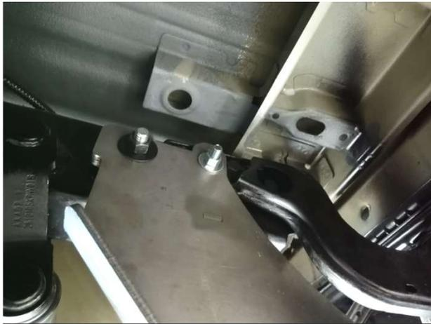
4. Localice los orificios en la cara interior del chasis foto 7, introduzca la guía para tornillo de 1/2" por el orificio más grande foto 8, que salga por el extremo del chasis foto 9.
