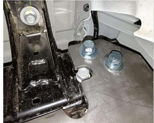
1. A su vez, que se posicionen los barrenos inferiores de la placa del tirón con los tornillos anteriormente instalados, como se muestra.
