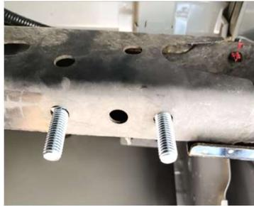
1. Retire los tornillos del chasis que se indican en la imagen.
