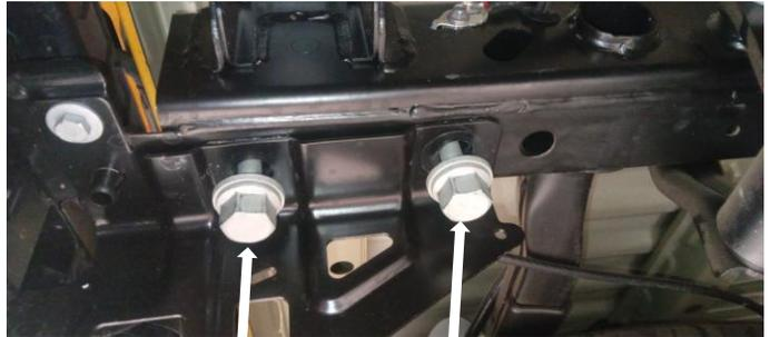
3. Enseguida localice por la parte lateral del chasis el barreno ovalado e instale el tornillo con solera soldada ayudándose con el empaque de vinil de forma que sujete el tornillo con solera para la instalación. **Foto 3 y 4.**
