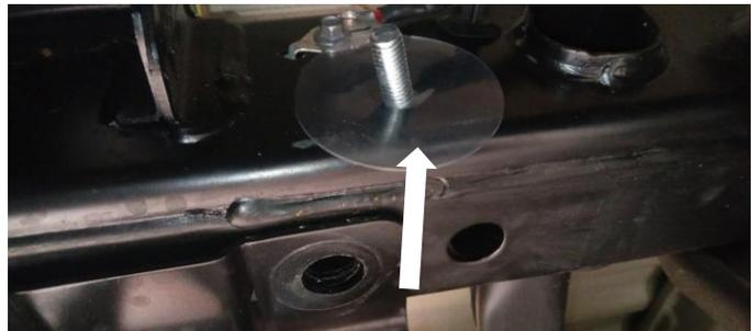
5. Alinee las placas del tirón de forma que enganche con el tornillo instalado en el paso anterior y que coincida con los orificios de la parte inferior del chasis enseguida coloque los espaciadores cuadrados entre el chasis y el Bracket e inserte los tornillos originales retirados en el paso anterior, en ambos lados. **Foto 5 y 6.**
