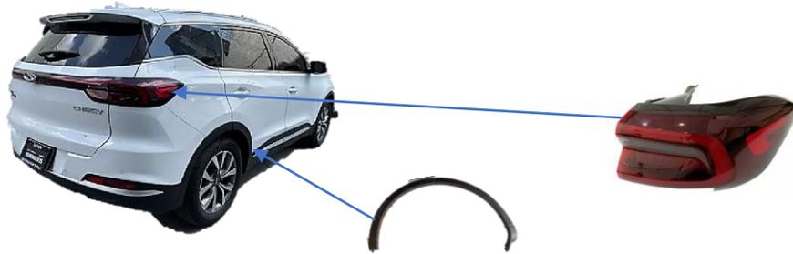
3. Coloque de nuevo las calaveras ya que no se pueden desconectar, desprenda la fascia y desconecte los cuartos, enseguida quite la defensa y corte una hendidura de 2 ½" x lo ancho del barreno original para que pueda entrar la solera de sujeción por el ducto.
