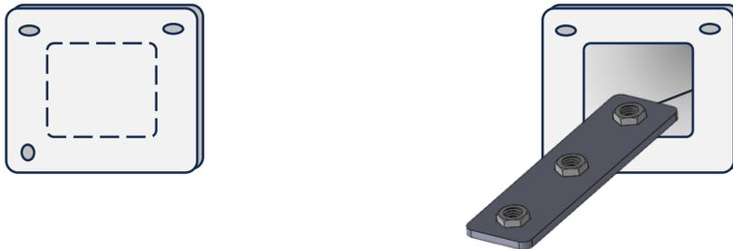
4. Proceda a abocardar los barrenos del ducto a 9/16" y coloque la solera de sujeción dentro del mismo para montar el tirón y marcar el barreno restante, continúe abocardando todos los barrenos a 9/16".
