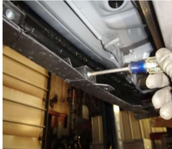
2. Utilice cinta de papel para marcar el soporte de la defensa, alineado con el barreno del soporte de la defensa y recorte en el centro.
