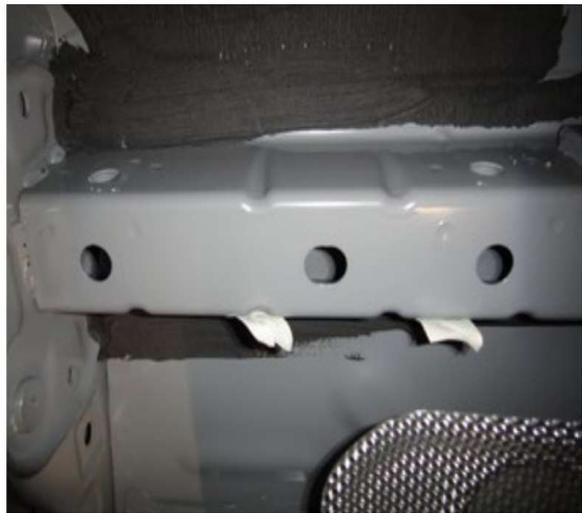
4. Presente el tirón en la posición correcta en los puntos de sujeción y asegure con tornillos cabeza hex. M12 x 45mm. ( 4 ), rondanas planas de ½" ( 4 ), rondanas de presión de ½" ( 4 ).
