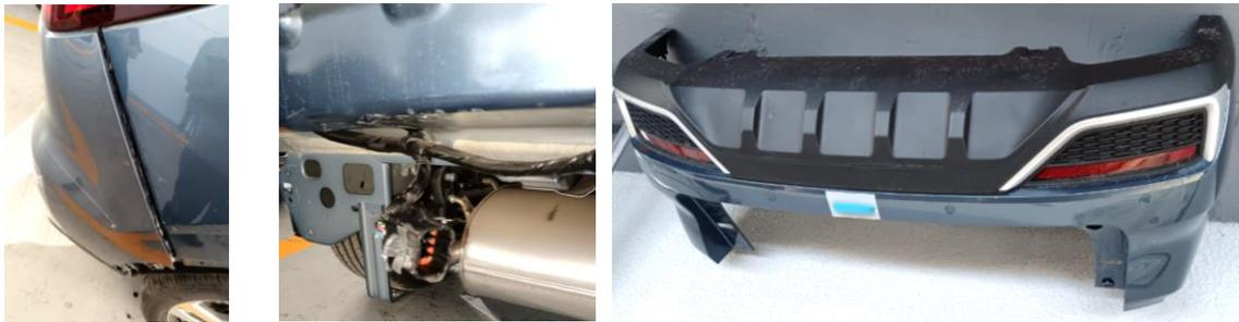
3. Retirar los tornillos para bajar el parachoques, bajar el escape, marcar en el costado vertical del lado del conductor el barreno a realizar.
