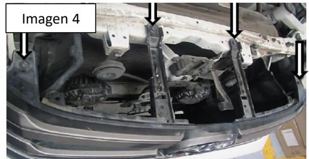
2. Localice los tres barrenos pasados en el larguero de chasis e instale los brackets utilizando (3) tornillos Hex. De  $\frac{1}{2}$ " x  $3 \frac{1}{2}$ ", (3) rondanas planas  $\frac{1}{2}$ " y (3) tuercas hex.  $\frac{1}{2}$ ". **(Imagen 5 y 6)**
