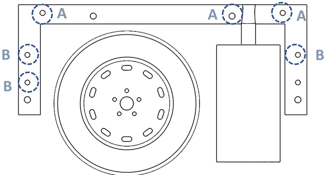
3. Con ayuda, levante el tirón hasta su posición y instálelo usando 3 tuercas, 3 rondanas planas y 3 rondanas de presión por lado. **(Foto 5)**
