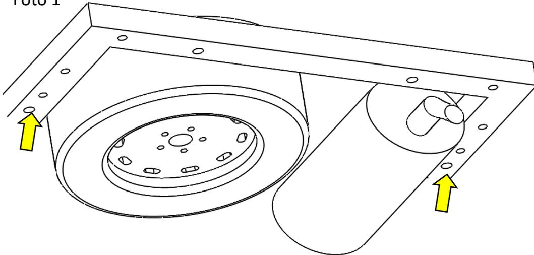
2. Ubique los barrenos donde deberá colocar las soleras con tornillo. En los barrenos marcados con la letra A podrá introducir la solera directamente en el barreno. En los marcados con la letra B use la guía de tornillos, introduzca y guie las soleras con y tornillo hasta que estas salgan por los agujeros del chasis. (**Foto 2**).
