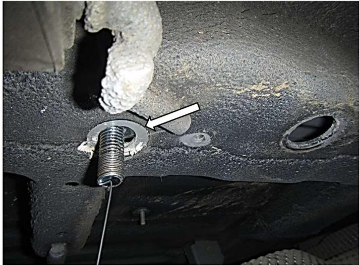
3. Introduzca el otro tornillo con solera como se muestra. **Foto 7.** Repita para el lado opuesto. Presente el tirón y asegure con rondana plástica ( para detener a los tornillos ) Rondana plana de 1/2" tuerca de seguridad como se muestra. **Foto 8 y 9.**
