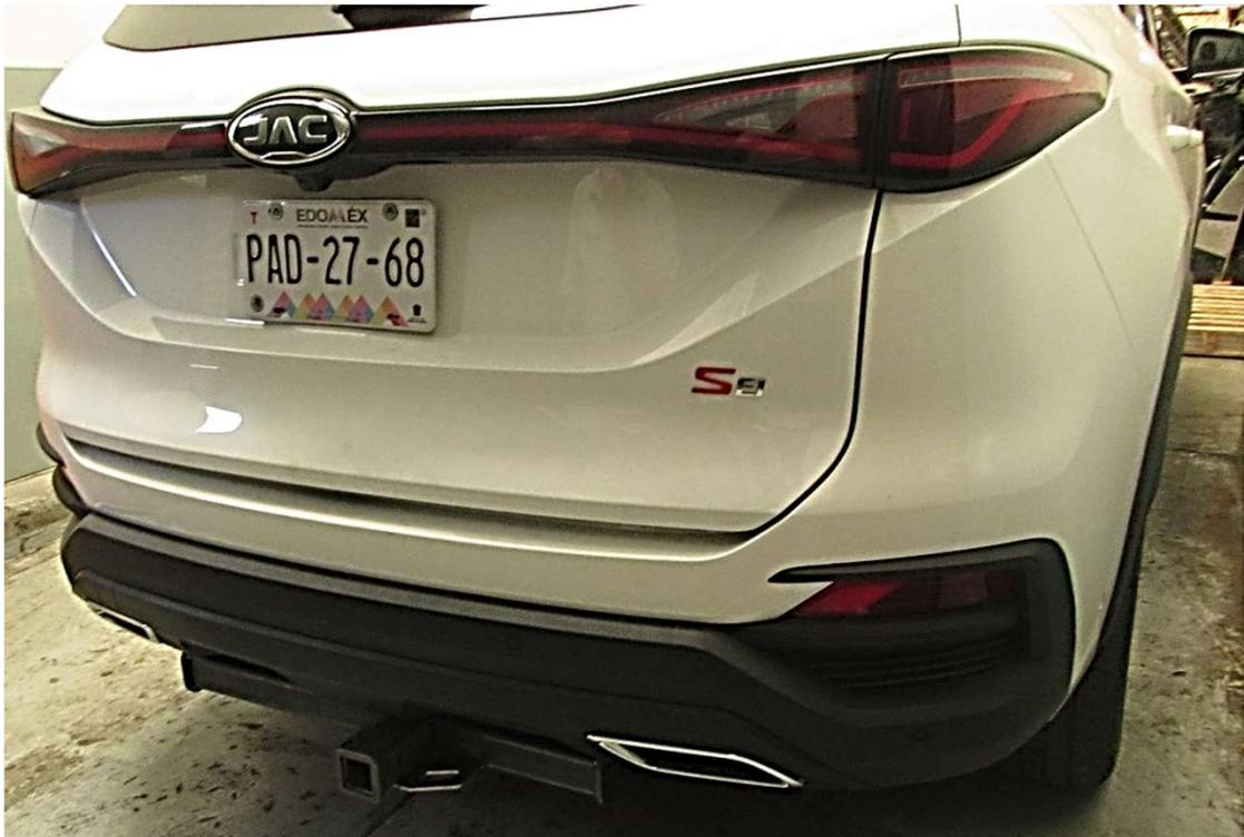
3. Haga cualquier ajuste final para la alineación del tirón y apriete toda la tornillería. Recuerde revisar y reapretar la tornillería periódicamente.
