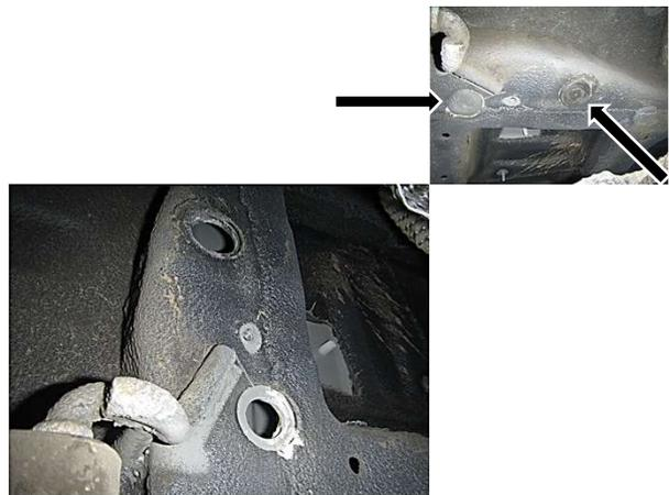
2. Va a introducir por el orificio pequeño la guía para tornillos, como se muestra. **Foto 3.** Debe de salir por el orificio grande, como se muestra. **Foto 4.**
