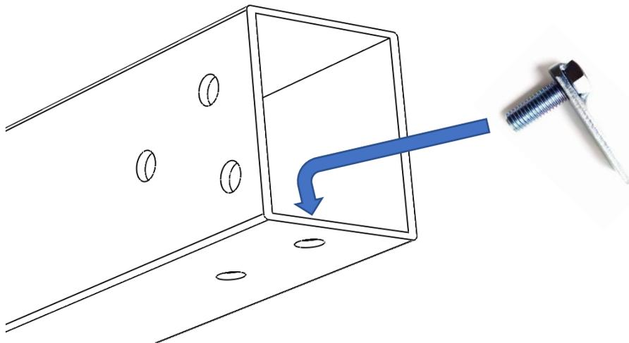
3. Con ayuda, levante el tirón hasta su posición y instálelo usando 2 tuercas, 2 rondanas planas y 2 rondanas de presión por lado. **(Foto 5)**
