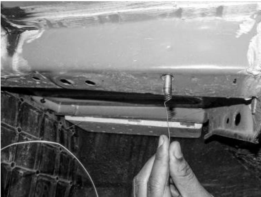
5. Con ayuda, levante el tirón hasta su posición y instálelo usando 3 tuercas, 3 rondanas planas y 3 rondanas de presión por lado. **(Foto 5)**
