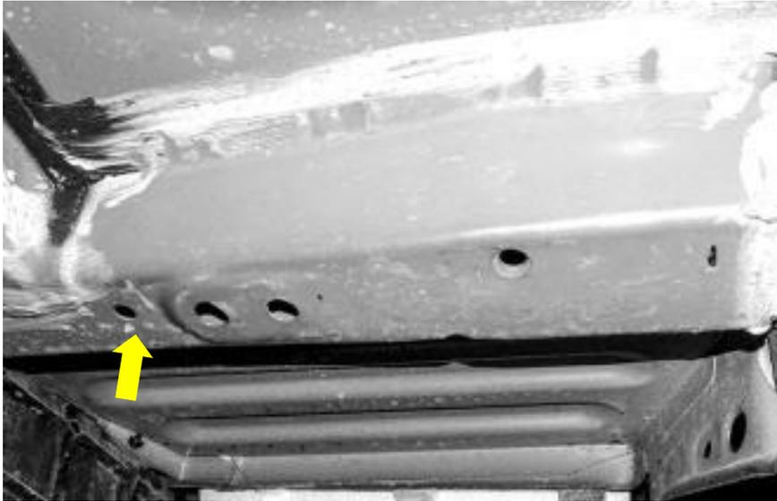
4. Usando la guía de tornillos, introduzca y guíe las soleras con y tornillo hasta que estas salgan por los agujeros del chasis. Necesitará 3 por lado (**Foto 4**).
