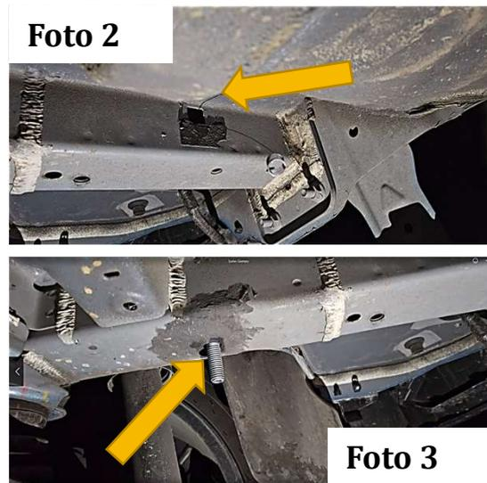
2. Por el rectángulo introduzca los tornillos con varilla, utilizando una guía para tornillo de 1/2", el tornillo debe de salir por los orificios inferiores como se muestra. **Foto 2 y 3.**
