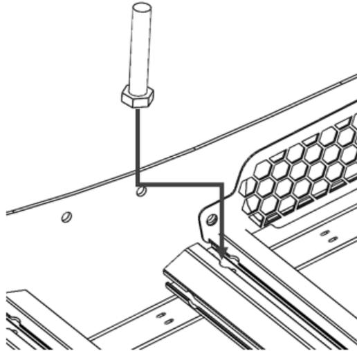
Con ayuda, Coloque la canastilla sobre el vehículo y póngala sobre los soportes. Instale usando (2) rondanas planas, (2) rondanas de seguridad y (2) tuercas de 1/4" por soporte. (Imagen 10)
