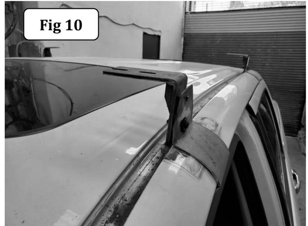
**Paso-8** Abra la puerta trasera, mida desde el bracket frontal aproximadamente 36 15/16", (Fig 11). Coloque el pie trasero en el canal de desague. Inserte el gancho del pie en el barreno superior de la uña trasera y posicione la uña trasera en el marco de la puerta. Asegure la uña trasera al pie trasero utilizando (1) 1/4 x 3/4" tornillo c/bola allen, rondanas plana, de presión y tuerca hex. (Fig 9 & 12).
