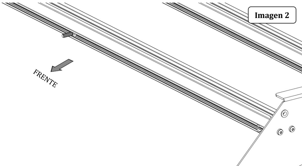
**Paso-4** Coloque el panel frontal alineando los barrenos con las tuercas inserto en el panel lateral y el bracket del panel con el tornillo instalado en la barra frontal. Atornille cada lado del panel lateral utilizando (2) tornillos cab. Bola allen  $\frac{1}{4}$ " x  $\frac{3}{4}$ " con su rondana plástica. Asegure al tornillo instalado en la barra utilizando (1) rondana de presión  $\frac{1}{4}$ " y (1) tuerca hex  $\frac{1}{4}$ ", (Imagen 3 & 4). Apriete los tornillos.
