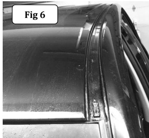
**Paso-6** Abra la puerta del conductor y mida aproximadamente 12" del parabrisas. Coloque el pie delantero en el canal de desagüe, (Fig 7). Inserte el gancho del pie en el barreno superior de la uña delantera y posicione la uña delantera en el marco de la puerta, (Fig 8). **NOTA:** La uña delantera es la más pequeña.
