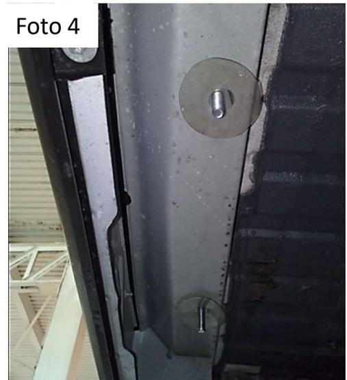
3. Use la guía de alambre para guiar la solera con tornillo de 3/8 (AST-RP01) a través del barreno mas grande y saquelo por el barreno pequeño que esta mas cerca del eje (**Foto 4 y 5**)
