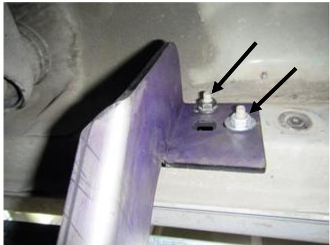
**Paso-4** Inserte el tornillo en la extrusión interior de aluminio por debajo del estribo en la posición que se requiera por la posición de los brackets. Cada estribo requiere ( 6 ) Tornillo hex. M8 x 25mm., 2 por el frente, 2 por la parte trasera y 2 por los galuces centrales como se muestra en la **foto 3 & 4**.
