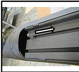
**Paso-6** Aliníe el estribo con el vehículo y apriete toda la tornillería. Repita los pasos anteriores para instalar los brackets y estribo del lado del pasajero. Recuerde checar y reapretar toda la tornillería cada 6 meses.
