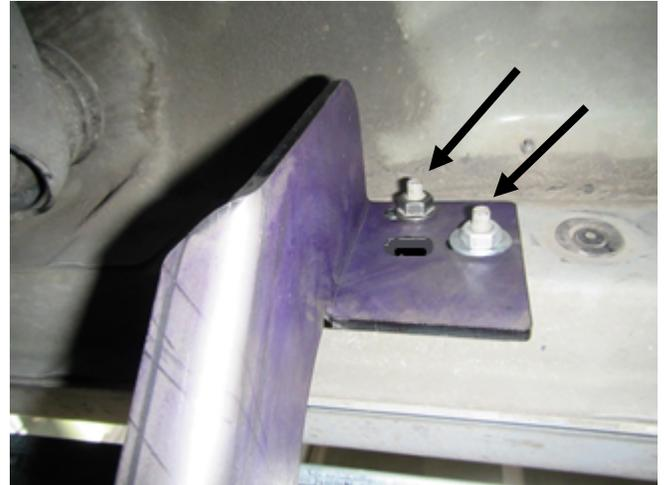
Paso-3 Instale el RB20 o RB 10 en el bracket instalado utilizando (6) tornillos hexagonales de 5/16 x 1", (6) rondanas plana de 5/16", (6) y rondanas de seguridad de 5/16" (Foto 3).
