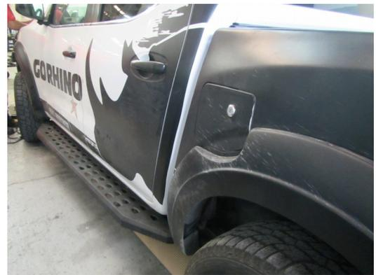
Paso-4 Alinee el estribo y apriete la tornillería. Repita los pasos en el lado del pasajero. No olvide revisar cada seis meses los tornillos y reapriete si es necesario.
