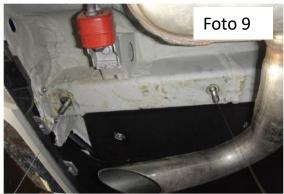
5. Levante el tirón a su posición, tenga cuidado de no golpear los tornillos. Asegure con tuercas de 1/2", rondanas planas de ½ y rondanas de presión de ½". Apriete todas las tuercas de 1/2" a 110 lb-ft. Vuelva a instalar los clips de retención y los sujetadores que se eliminaron en los pasos 1 y 2. (Foto 10 y 11)
