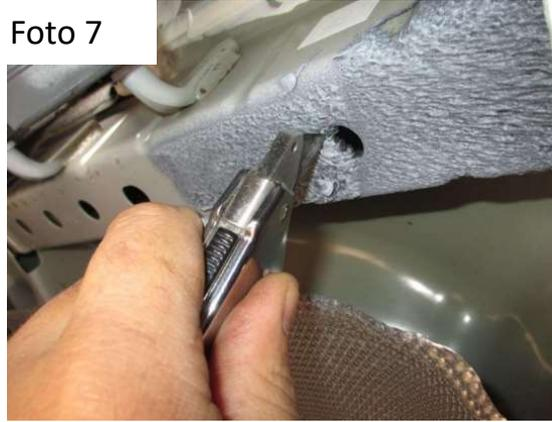
4. Utilizando la guía de tornillos. Guíe las soleras con tornillos por el coloque una rondana de vinil en cada tornillo. Esto ayudara a mantenerlas en posición para maniobrar con el tirón. (Foto 8).
