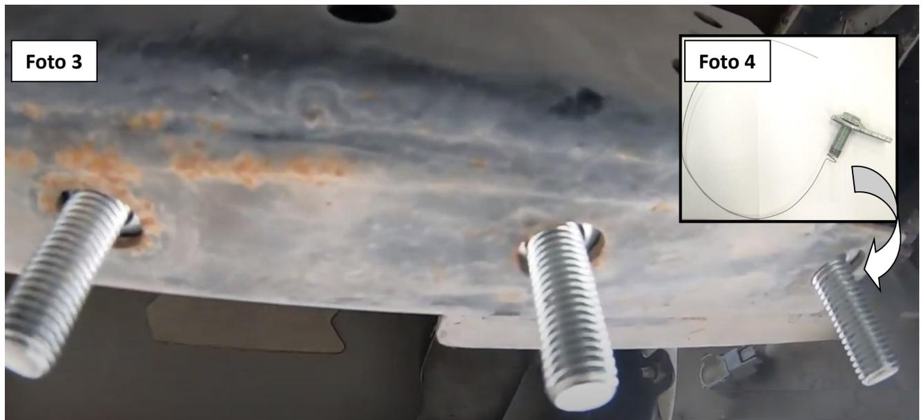
3. Presente el Tirón en el vehículo e instale el lado del pasajero con (3) rondanas planas y (3) tuerca de seguridad. No apriete aún **Foto 5**. Repita para el lado contrario o, en su defecto, reinstale los tornillos milimétricos del gancho desinstalado **Foto 6**. No apriete aún.
