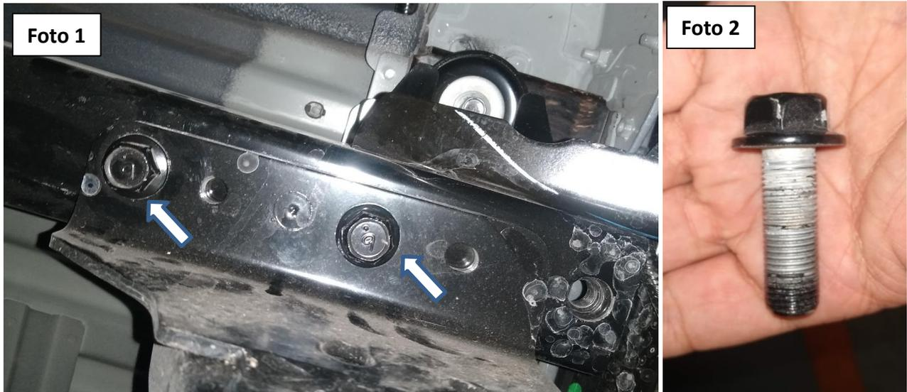
2. Introduzca dentro del chasis del lado del pasajero (3) Soleras con tornillo de  $\frac{1}{2} \times 1 \frac{1}{2}$ " utilizando la guía para tornillo, los tornillos deben de apuntar hacia abajo como se muestra en la imagen **Foto 3 y 4**. Si el lado del conductor no tenía el gancho desinstalado, repita la operación con las soleras con tornillo en ese lado.
