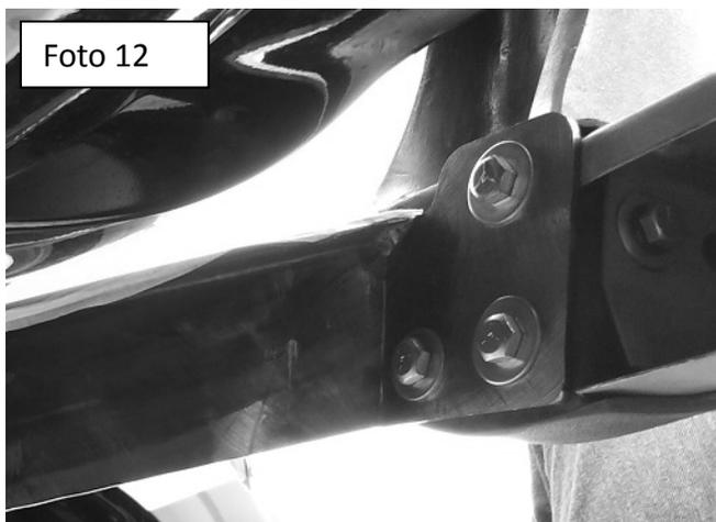
11. Fije el bracket auxiliar al Xtreme Guard con un tornillo 1/4 x 1", rondana plana y de presión, por cada lado. No apriete aún. **Foto 13.**
