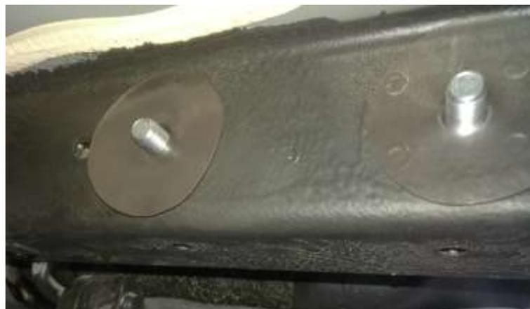
**4.3** Del lado del pasajero, Ubique el barreno de  $\frac{3}{4}$ " de diámetro, en la parte inferior de la camioneta. Puede ser necesario retirar un tapón plástico. Utilicé DOS guías de tornillos de  $\frac{7}{16}$ " y guie dos tornillos con varilla de  $\frac{7}{16}$ ". En este caso **NO SAQUE LOS TORNILLOS AUN POR LOS ORIFICIOS**, necesario que solo salga la punta de la guía de alambre. Los tornillos se jalarán hacia afuera una vez que el tirón esté en posición.
