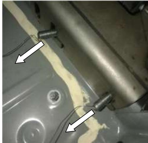
**4.6** Por último, instale (2) tornillos M10 x 30, (2) rondanas planas 7/16", (2) rondanas de seguridad 7/16" en el ultimo galuz del tirón, aprovechando la tuerca soldada del chasis.
