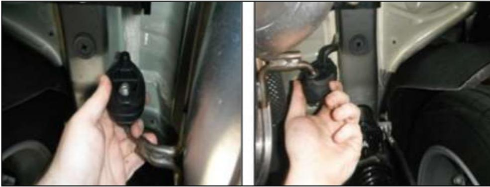
7. Reapriete la tornillería. Presente las cubiertas de plástico previamente retiradas, en la del lado del pasajero marque donde quedan los tornillos de instalación y corte dos barrenos para librar los mismos. Vuelva a colocar las cubiertas inferiores.
