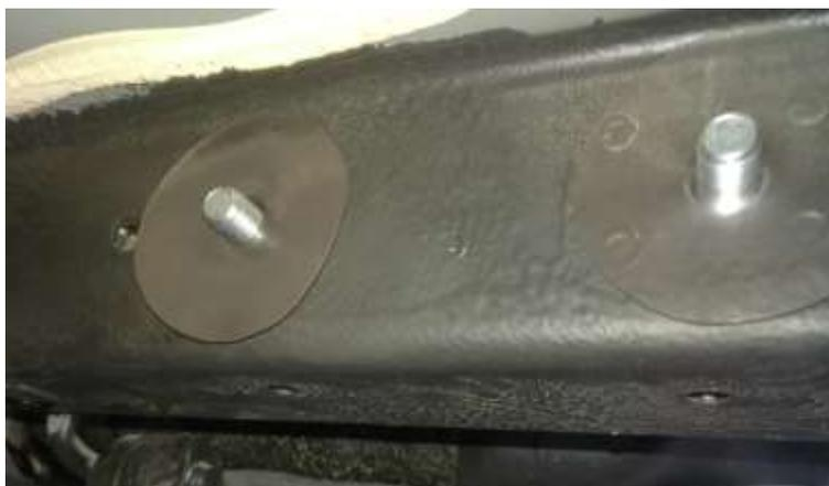
**5.3** Del lado del pasajero, Ubique el barreno de  $\frac{3}{4}$ " de diámetro, en la parte inferior de la camioneta. Puede ser necesario retirar un tapón plástico. Utilicé DOS guías de tornillos de  $\frac{7}{16}$ " y guie dos tornillos con varilla de  $\frac{7}{16}$ ". En este caso **NO SAQUE LOS TORNILLOS AUN POR LOS ORIFICIOS**, necesario que solo salga la punta de la guía de alambre. Los tornillos se jalarán hacia afuera una vez que el tirón esté en posición.
