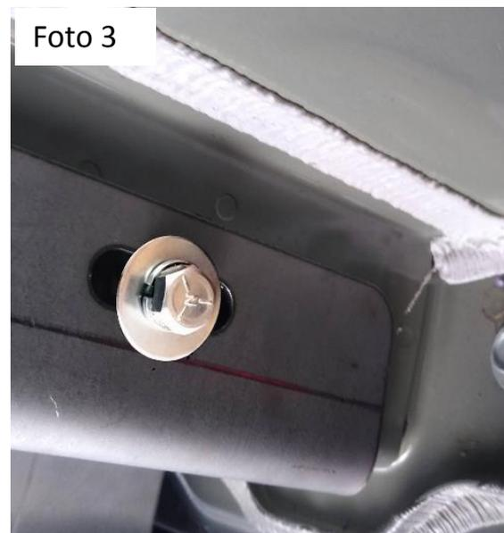
3. Alinee el tirón y apriete toda la tornillería. Reinstale el escape en su posición original. Revise y reapriete la tornillería de ser necesario cada 6 meses. **(Foto 4)**
