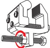
**5 Alt. b.** Thread the stand-off jam nut onto the bolt.
