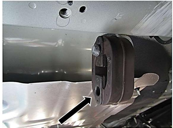
2. Localice la tolva plástica lado pasajero y retírela para mejor acceso. Retire la tuerca plástica superior y los dos pines inferiores. ( Manualmente ) Retire el tornillo superior externo utilizando dado 12mm. **Foto 3 y 4.**
