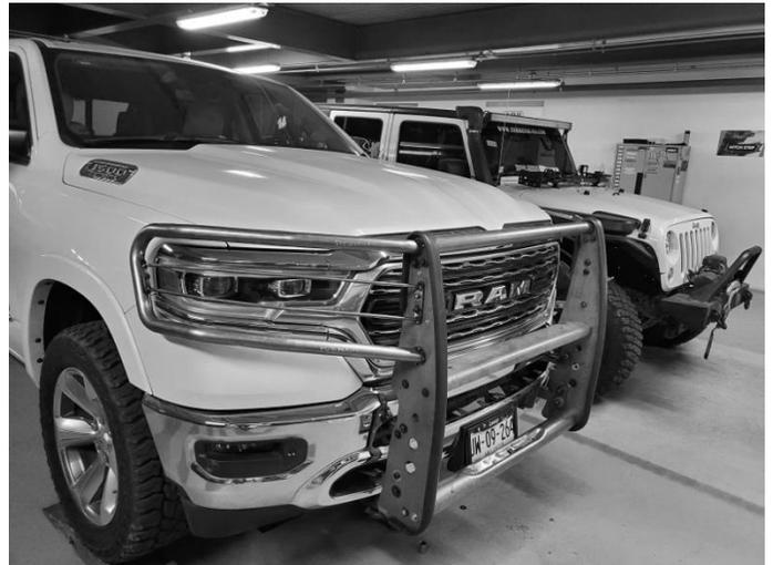
**Paso-10** Posicione el Grille Guard en los brackets inferiores y superiores. Imagen 9. Asegure a los bracket inferiores con (2) tornillos c/hex 1/2 x 1 1/2", (4) rondanas planas 1/2", (2) rondanas de presión 1/2" y (2) tuercas hex 1/2". Fije a los brackets superiores utilizando (2) tornillos c/hex 3/8 x 1 1/4", (2) rondanas planas 3/8", (2) rondanas de presión 3/8" y (2) tuerca hex 3/8". No apriete aún. Imagen 10.
