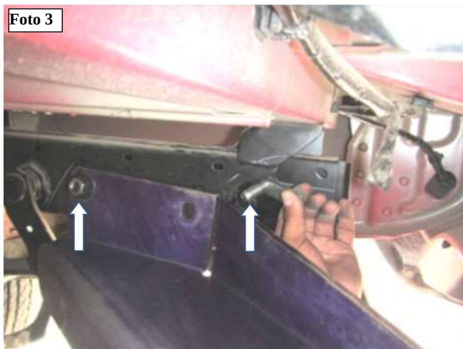
4. Introduzca ( 2 ) soleras con tornillo en los barrenos inferiores por el extremo abierto del chasis utilizando la guía para tornillo de  $\frac{1}{2}$ ". **Foto 4.** No apriete aún. Repita para el lado contrario.
