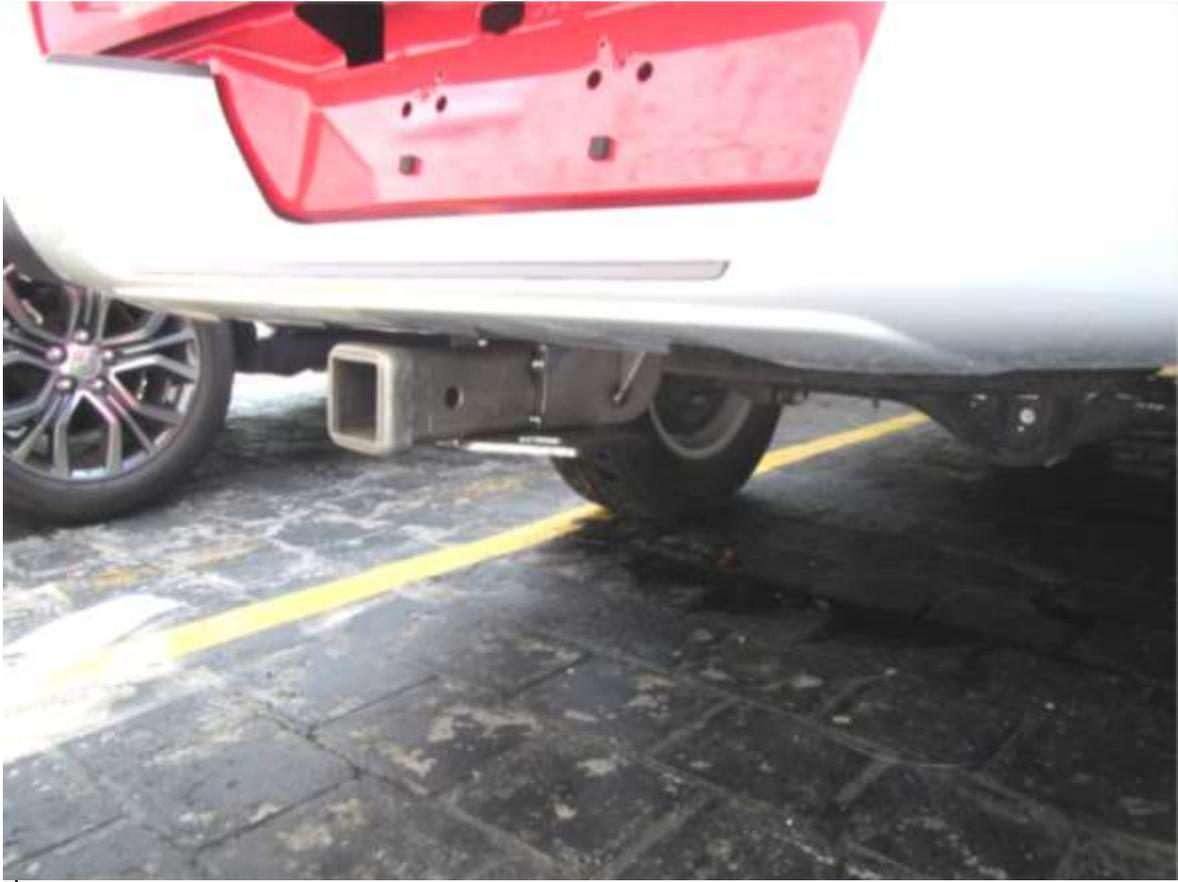
6. Alinee el tirón en el vehículo y apriete toda la tornillería Reapriete la tornillería periódicamente.
