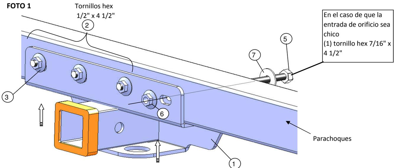
**Nota: Revisar periódicamente los tornillos para asegurar que esten correctamente ajustados.**
