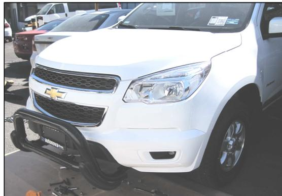
9. Si desea instalar el deflector, sobrepóngalo en la posición de donde fue removido, y trace en donde interfiere con los brackets del Bull Bar Dakar para cortar. Ya que cortó el deflector, reinstálelo.
