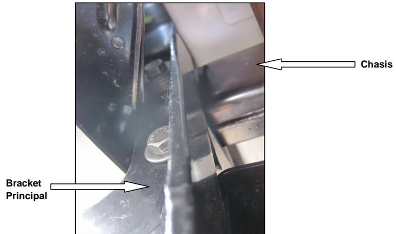
5. Localice los barrenos existentes en el chasis del vehículo, coloque el bracket principal y asegúrelo al chasis en el barreno existente delantero utilizando: (1) Torn. Cab.Hex. 7/16" X 3 1/2", (2) Rondana Plana 7/16", (1) Rondana de presión 7/16", (1) Tuerca Hexagonal 7/16". El bracket principal va en la cara externa del chasis y el bracket auxiliar debe instalarlo en la cara interna del chasis y fjelo con la misma tornillería antes mencionada por cada lado. No apriete aún. **Foto 2.**
