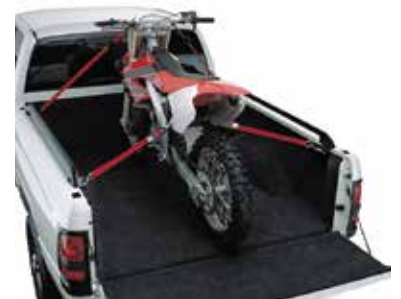
Cintas que mantienen la carga sin desplazamiento
