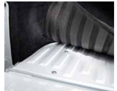
Ajuste a la medida del contorno de la caja.No se acumulan escombros debido a la bisagra.
