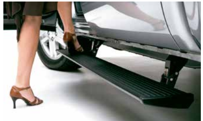
Se extiende al abrir la puerta
